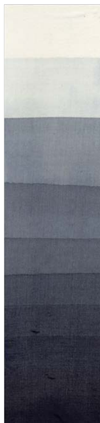
◀図 3-5 絹 9 段階ともはっきりと識別できた。絹は麻紙よりも表面がより滑らかであるため、絵具の定着は塗り重ねる度に安定し、色の濃さや発色の強さが深まった。
