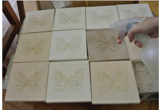
▲図 3-25 霧吹きで礬水液をかける。
