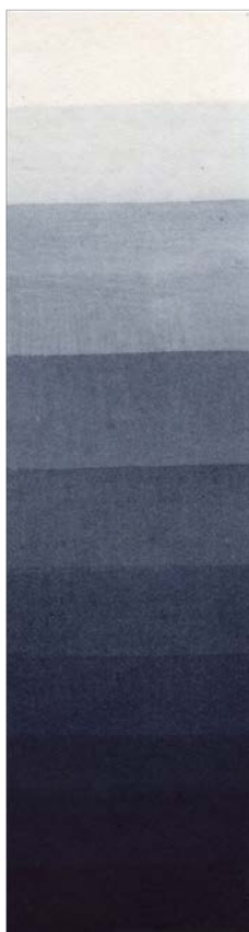
◀図 3-4 麻紙 9 段階ともはっきりと識別できた。麻紙は表面が滑らかであるため、絵具の定着は塗り重ねる度に安定し、色の濃さや発色の強さも深まった。
