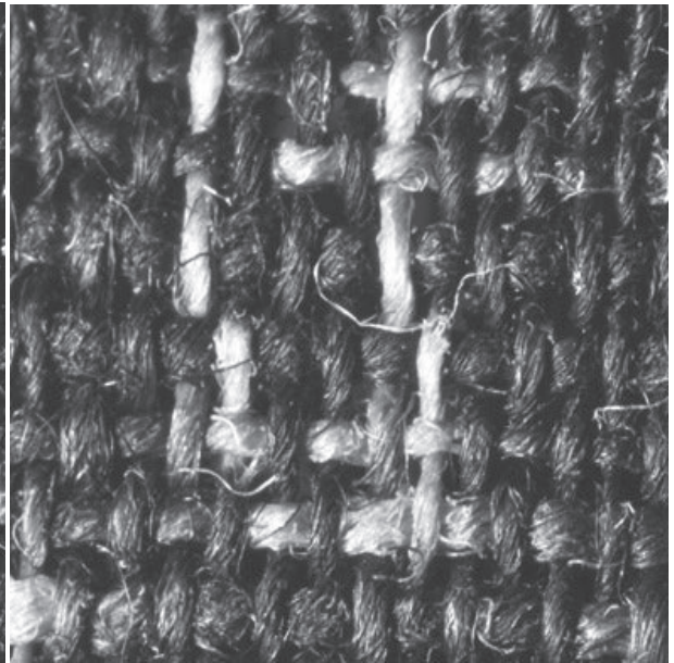
写真 16 単糸 Z 撚り (26 番程度) 糸幅平均 0.27mm 小禄クンジー資料 H19-55 (5mm × 5mm)
