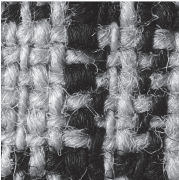
写真11 経糸単糸 S 撚り (10 番程度) 糸幅平均 0.42mm 日本民藝館田中俊雄資料 209 (5mm × 5mm)
