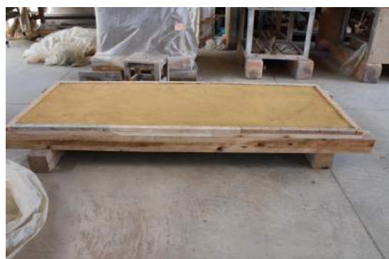
①分割なし、脚なし（木枠の縁まで赤土を乗せた状態）
