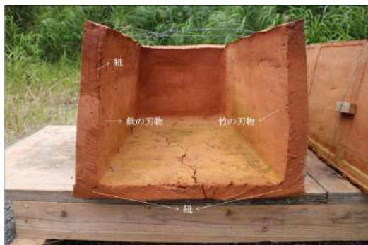
第 3 回陶棺切断実験 (中央切断面)
