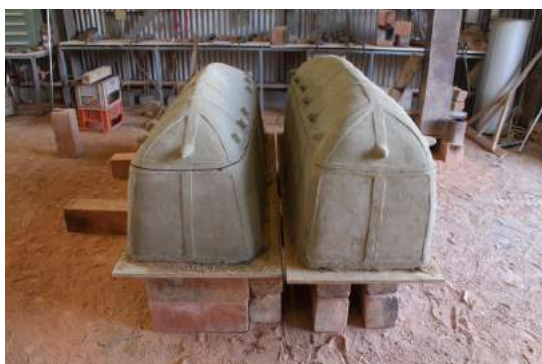
①分割なし、脚なし ②分割あり、脚なし（窯の設置）
