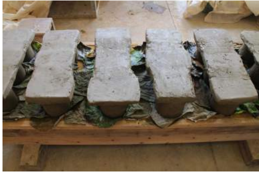
③分割あり、脚あり（脚と脚の間に脚と同じ硬度の粘土の塊を入れて製作）
