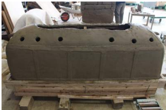
①分割なし、脚なし（二回目、棺蓋の突起部分の製作）
