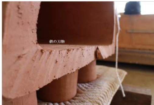
第4回陶棺切断実験中央切断面（鉄の刃物の切断面）
