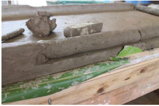
①分割なし、脚なし（二回目、陶棺壁の製作）
