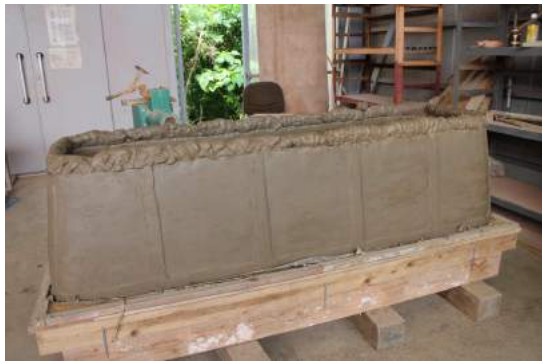
①分割なし、脚なし（二回目、陶棺壁完了）
