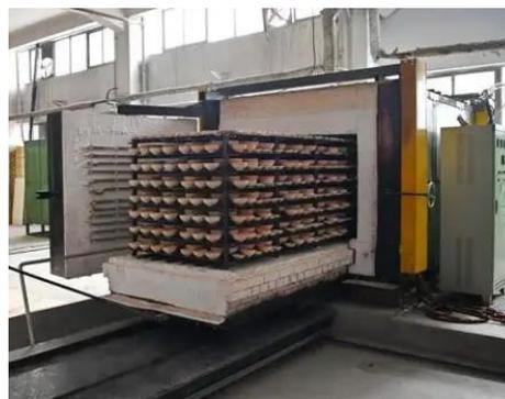
図 3. 33 台車窯 (左：ガス燃料 右：電気窯)
