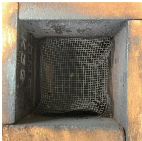
窯・上段（金網で段を組みテストピースを置く）
