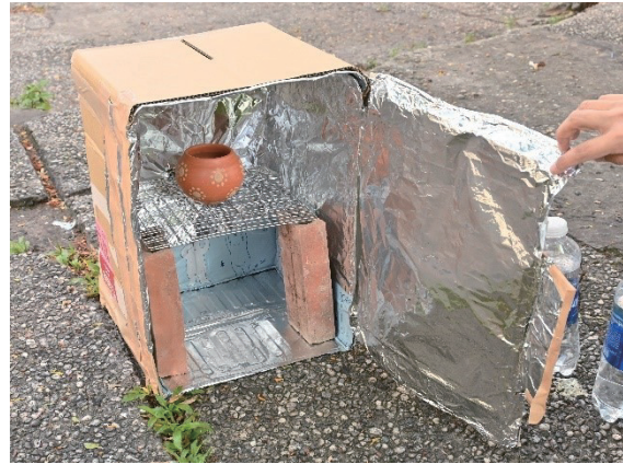
図 2-122：現地で調達できる材料で制作した簡易窯
