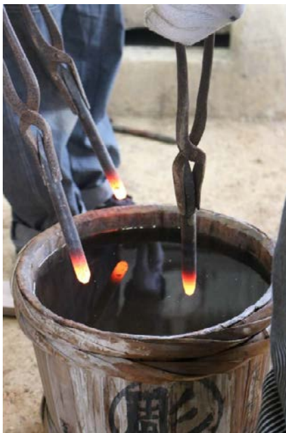
写真3 頭部分の焼き入れ、約 800℃まで温度が下がるのを待っている。
