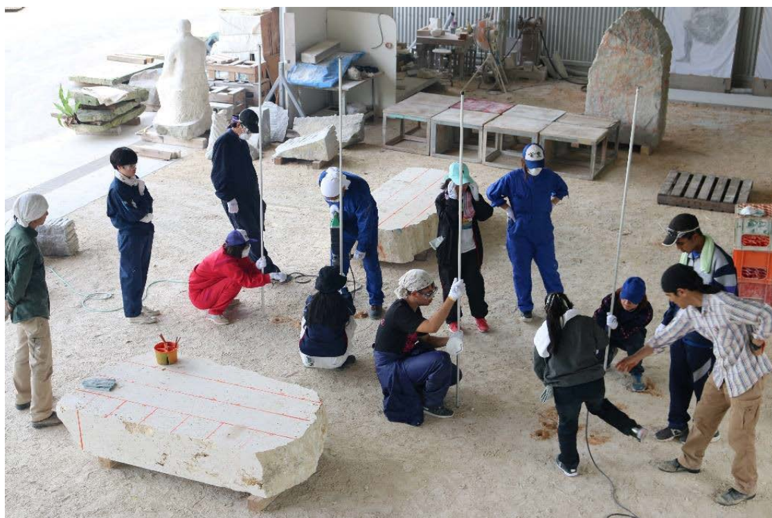
写真4 石割の練習、ドリルの安全な使用法を学ぶ。
