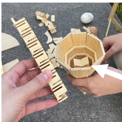
緩衝要素を組み合わせた案。卵の上下および側面方向に緩衝要素を配置。
