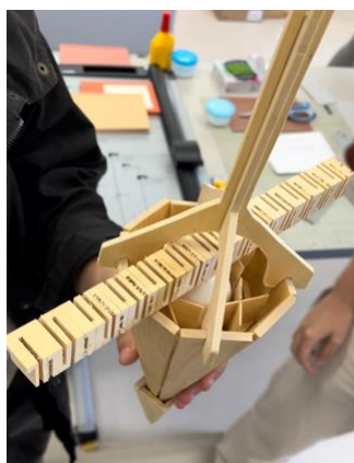
緩衝要素を組み合わせた案。卵の上下および側面方向に緩衝要素を配置。
