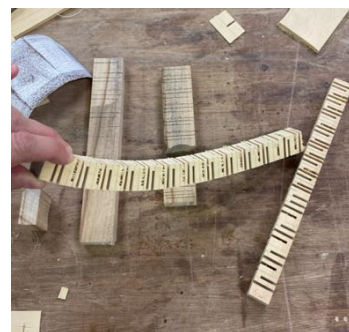
加工により木材が曲がる緩衝要素 既存方法を調べ、実践している。
