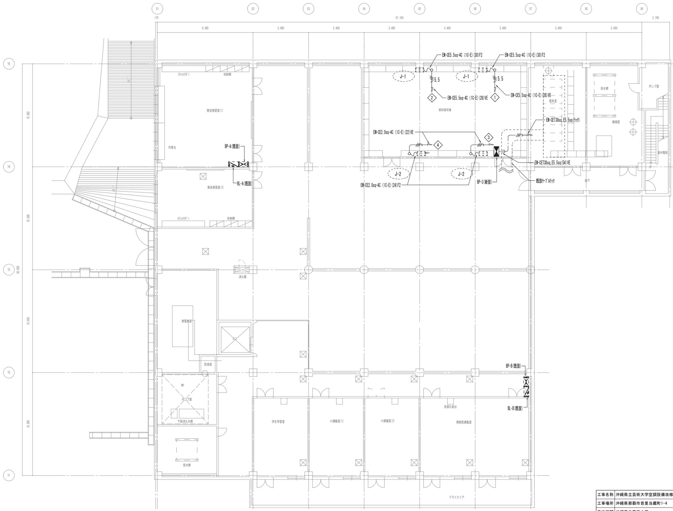
**B1階幹線・動力設備配線図 S=1/100**
