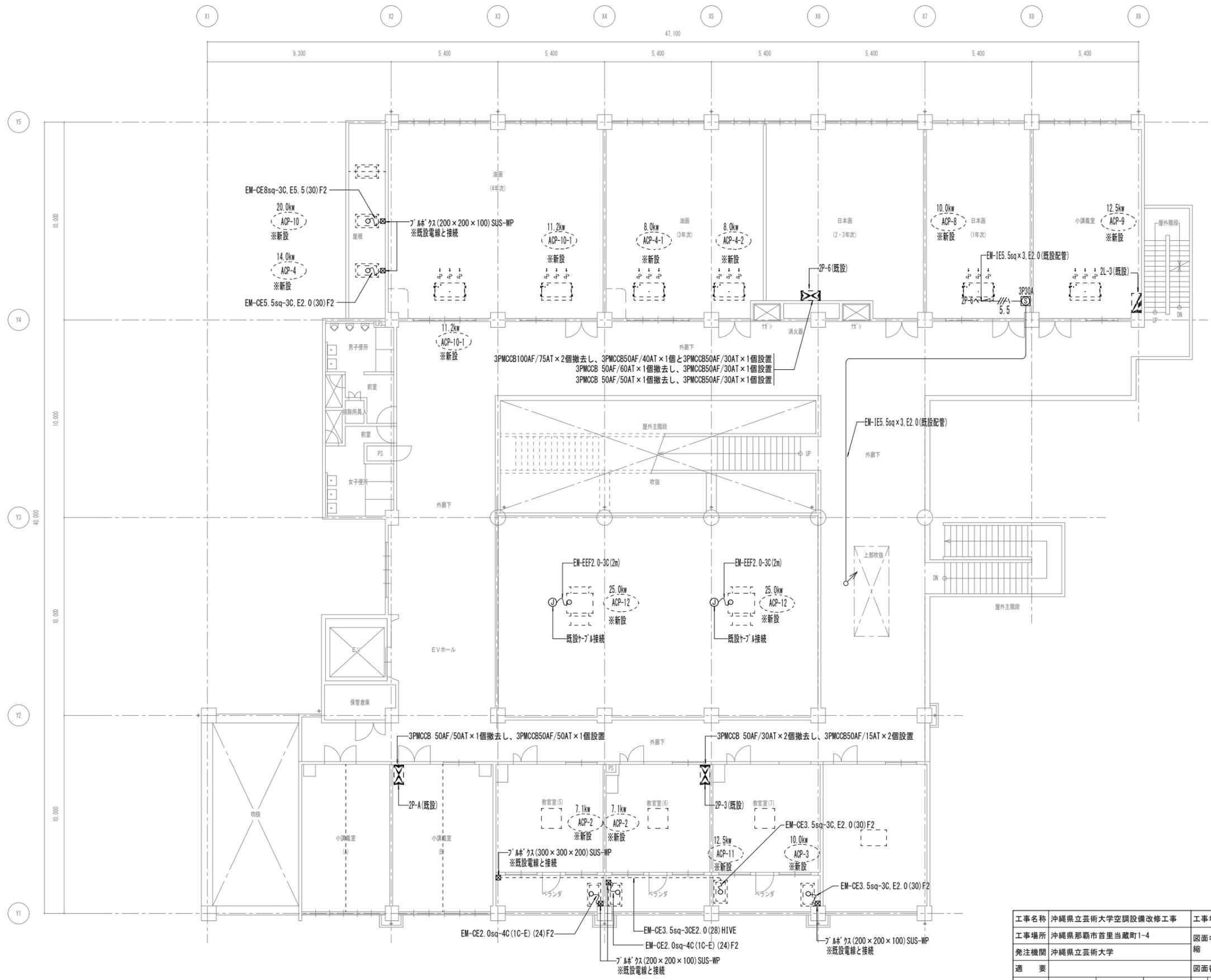
2階幹線・動力設備配線図 S=1/100 (新設)
